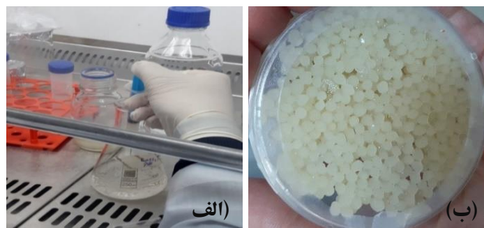
شکل ۱- تصویر آزمایشگاهی مراحل انجام فرایند انکپسولاسیون (الف) و مورفولوژی کپسول های مرطوب (ب).
