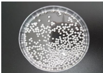
شکل ۴. میکروبیدهای آلژینات کلسیم
